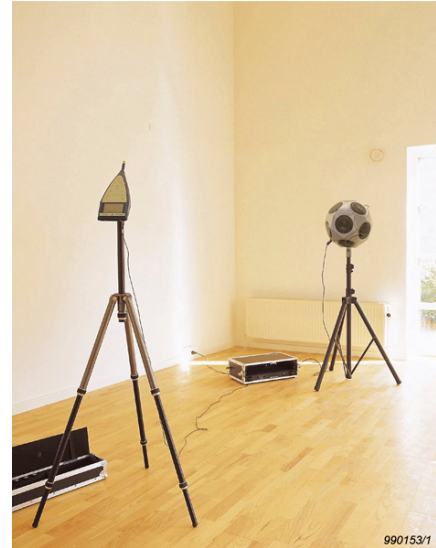
Medição Acústica de Edifícios
